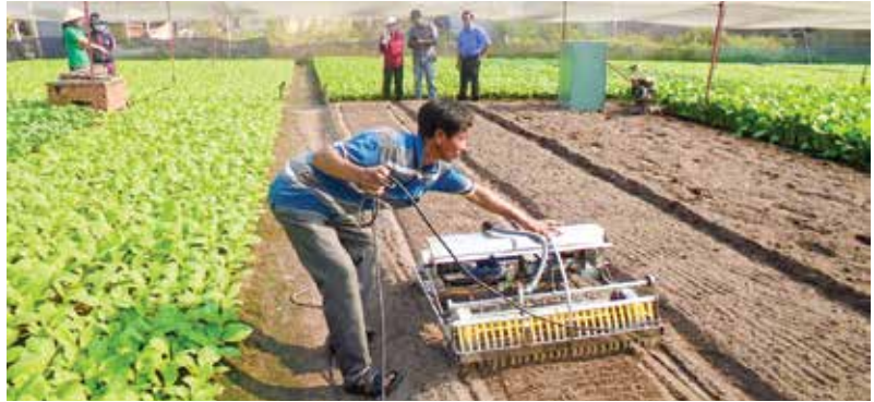
Mô hình cơ giới hóa- sử dụng máy gieo hạt trong trồng rau ăn lá
