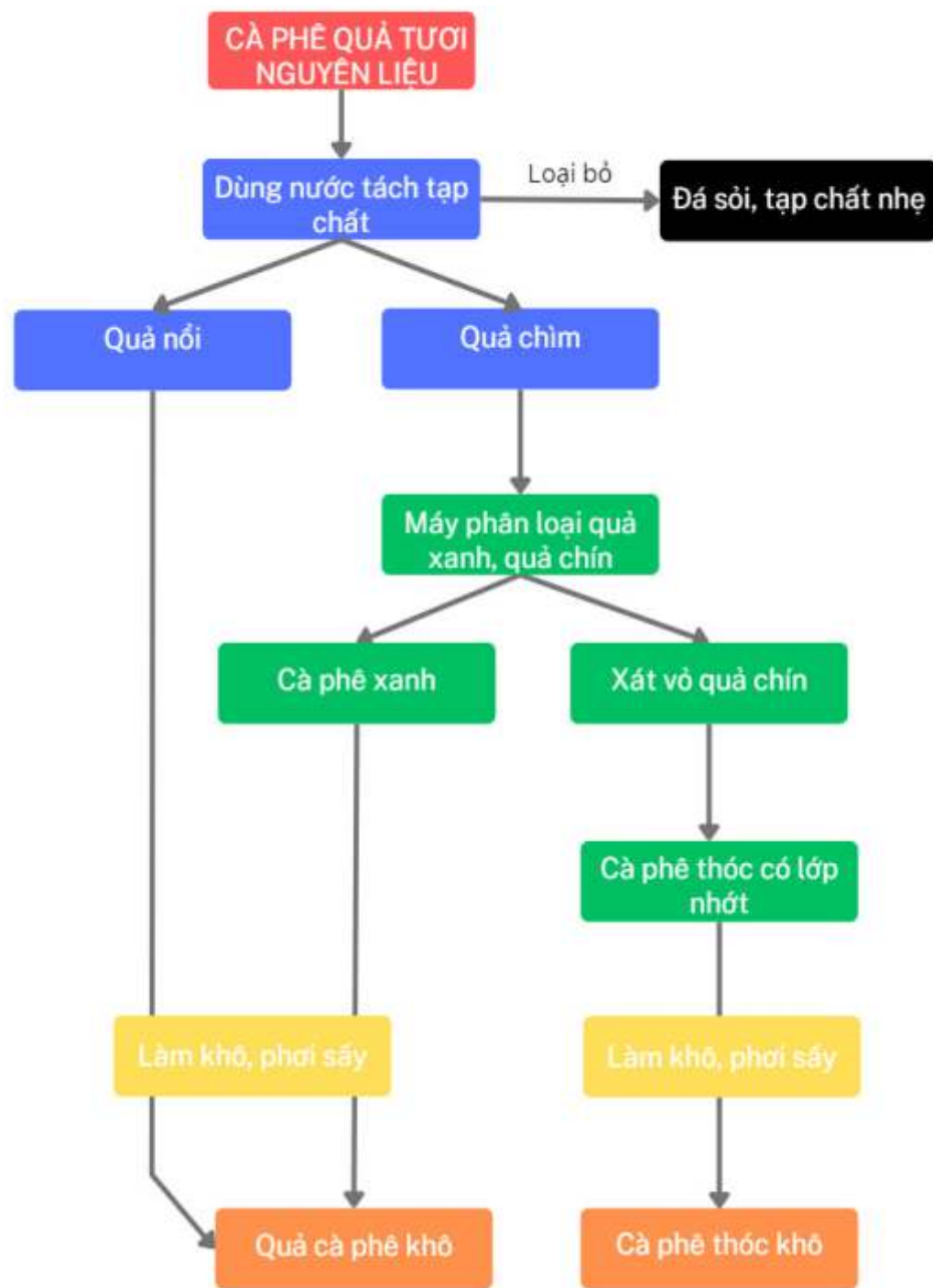
Sơ đồ 8. Quy trình chế biến cà phê theo phương pháp mật ong (chế biến bán khô)
