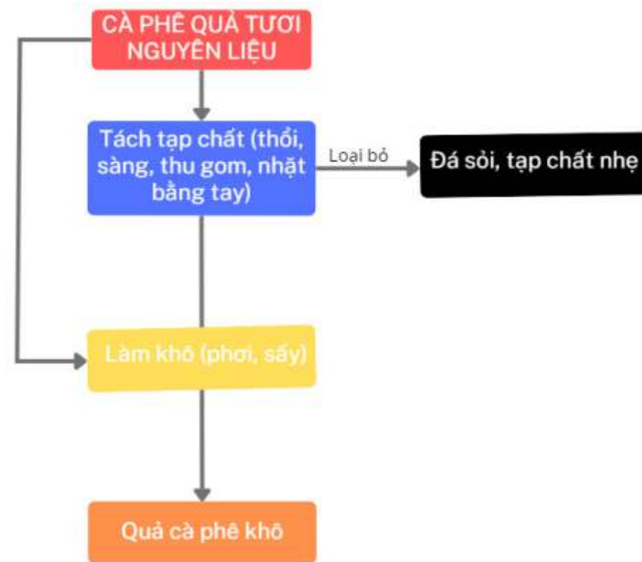
Sơ đồ 9. Quy trình chế biến cà phê theo phương pháp chế biến khô
