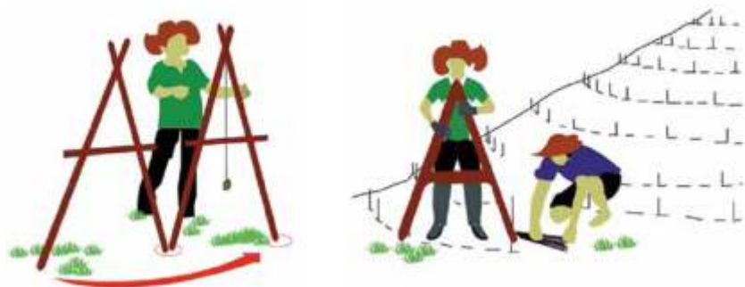
Hình 46. Cách sử dụng thang chữ A xác định đường đồng mức
