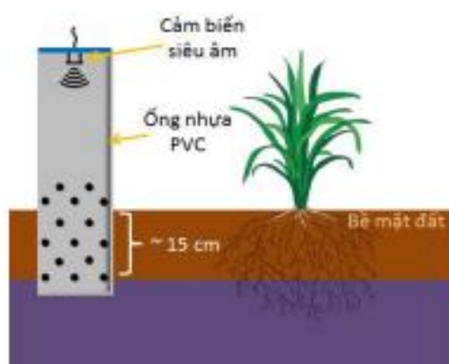
Hình 2.11. Cách đo mực nước bằng sử dụng cảm biến
