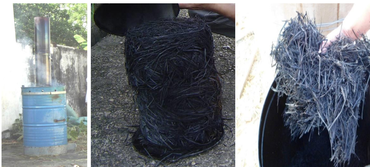
Hình 4.9. Sản xuất than sinh học bằng lò nung Hải Phúc, Hải Hậu, Nam Định
