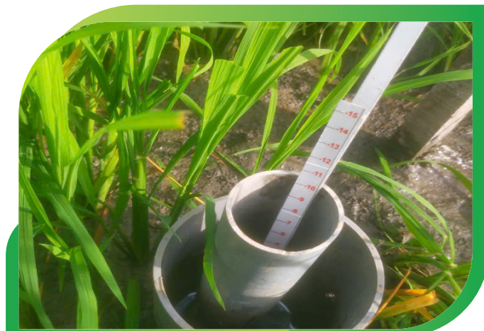
Đặt ống và thước để theo dõi mực nước trong ruộng
