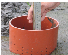
Dùng thước đo để theo dõi mực nước
