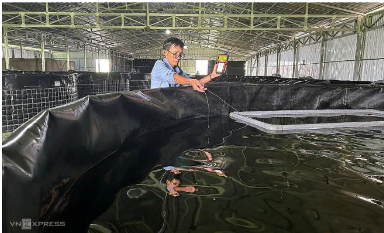
Đo nồng độ oxy trong nước tại trang trại nuôi cá chình
