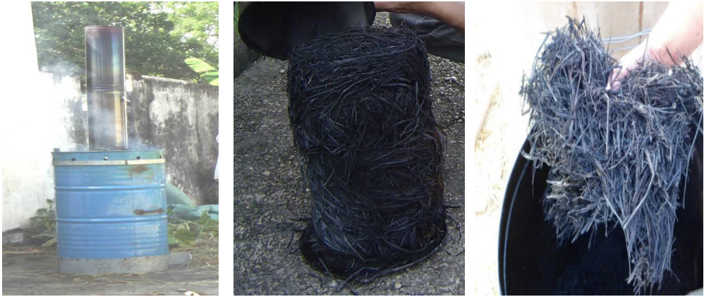
Hình 4.9. Sản xuất than sinh học bằng lò nung Hải Phúc, Hải Hậu, Nam Định
