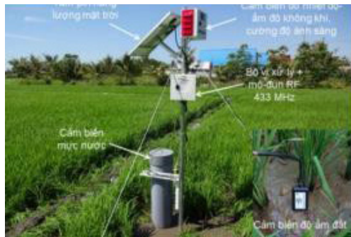
Hình 2.11. Cách đo mực nước bằng sử dụng cảm biến
