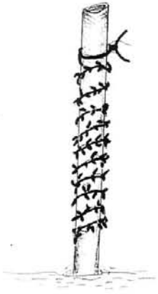
Hình 7: Cọc gỗ có quán dây treo Vem. \phi : 10 - 15cm; Dài: 2,0 - 2,5m.
