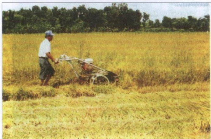
Hình 12. Máy gặt rải hàng GX-120 làm việc trên đồng (Cơ khí An Giang chế tạo)
