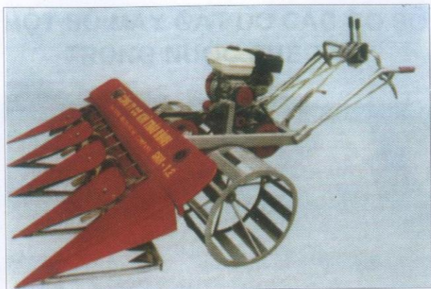
Hình 9. Máy gặt lúa rải hàng GRH-1,2 do Công ty cơ khí Thái Bình chế tạo
