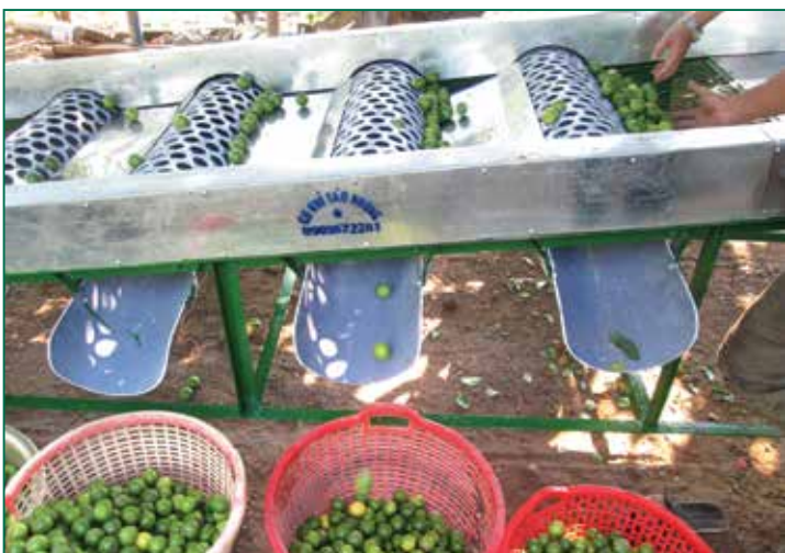
Thiết bị sàng phân loại chanh có thiết kế đơn giản, nhỏ gọn
