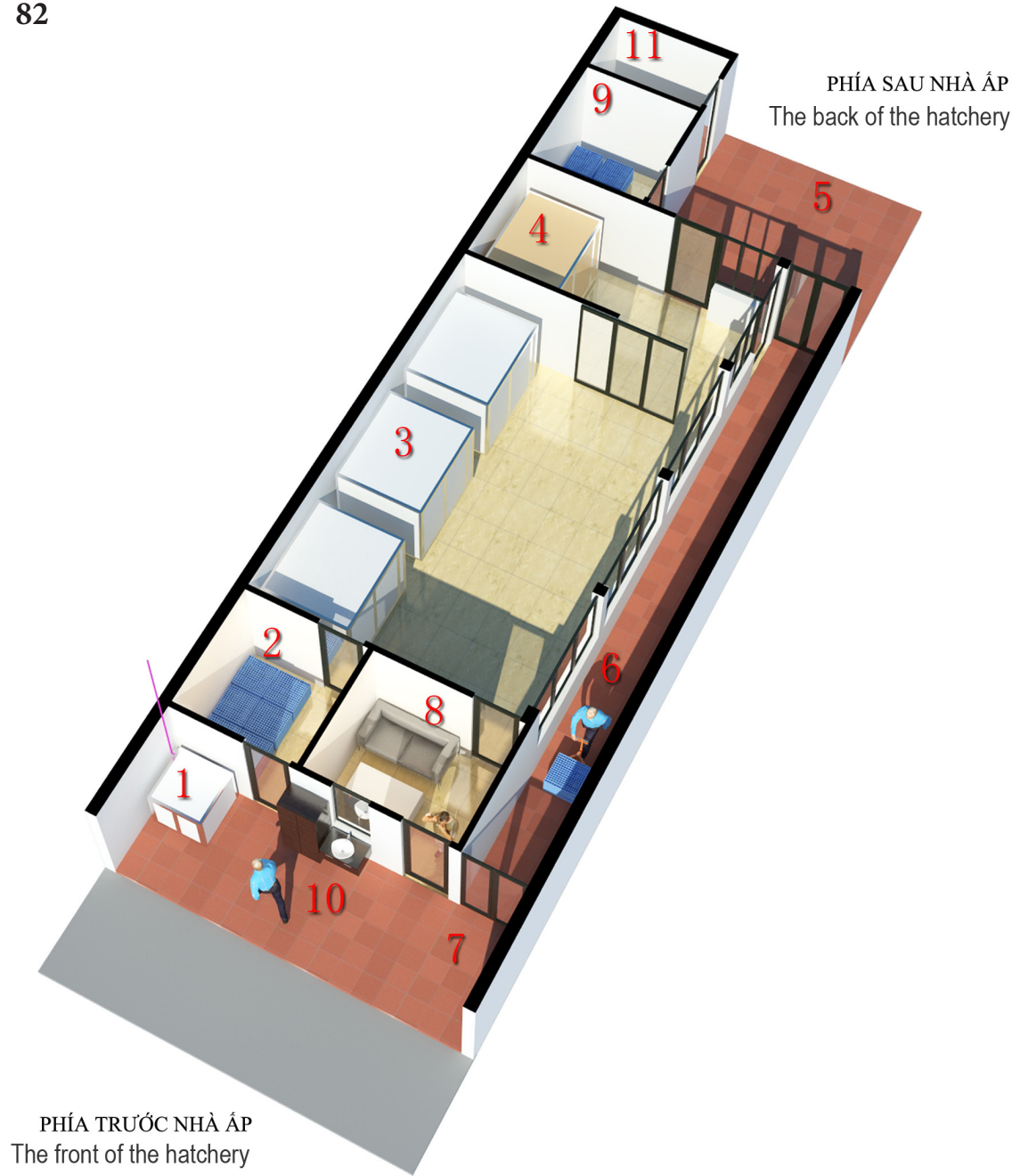
MÔ HÌNH 1. MẶT BẰNG CƠ SỞ ẤP TRỨNG XÂY TRÊN KHU ĐẤT 1 LỐI VÀO Design 1. Hatchery layout built on a rectangle area with 1 entrance
