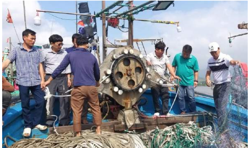
Mô hình tời thủy lực thu lưới rê tầng đáy cho các đội tàu khai thác hải sản xa bờ
