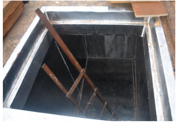
Hầm tàu sau khi được bọc inox 304
