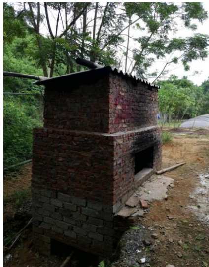
Hình 92. Lò đốt xác lợn chết sử dụng khí gas tự nhiên (Trần Văn Phùng)
