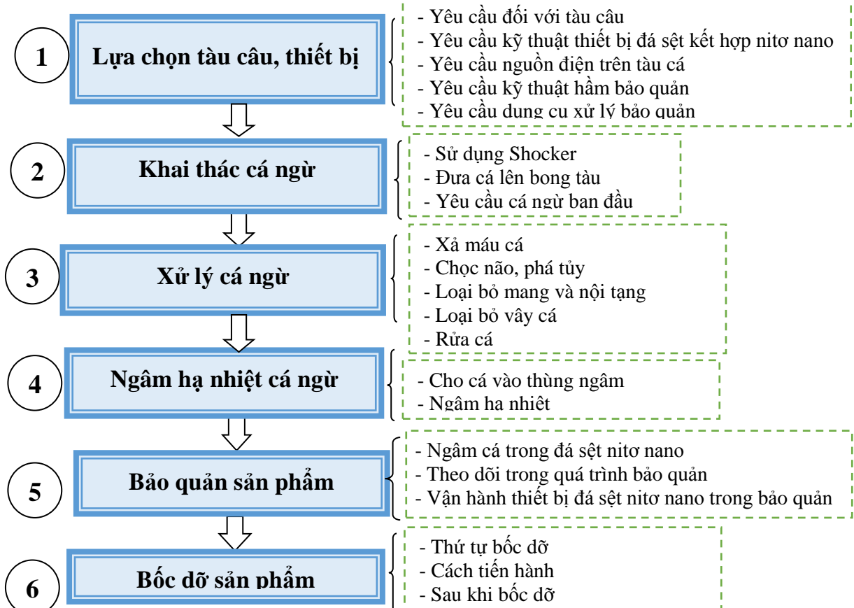
Hình 1. Sơ đồ tóm tắt quy trình công nghệ bảo quản cá ngừ đại dương trên tàu cá ngừ bằng đá sệt kết hợp khí nitơ nano
